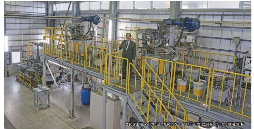
さぬき工場マイクロ波と熱によるハイブリッド炭化炉1基、アルカリ類活炉1基
